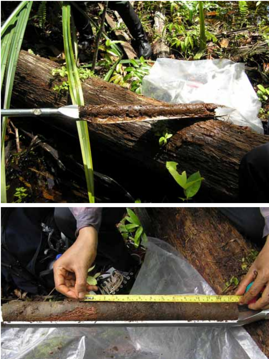
Gambar 8. Contoh tanah gambut yang baru dikeluarkan dari tabung bor. Gambut pada gambar bawah lebih matang dibandingkan gambut pada gambar atas.
