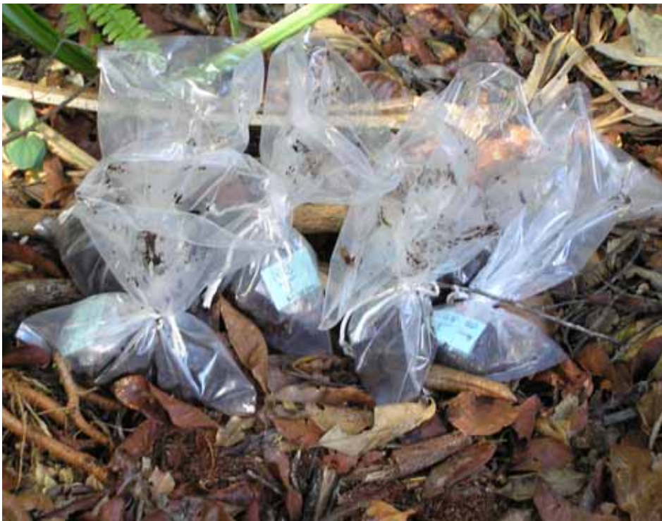
Gambar 9. Contoh gambut di dalam kantong plastik, dengan label yang lengkap dan tertutup rapat, siap diangkut ke laboratorium untuk analisis.
