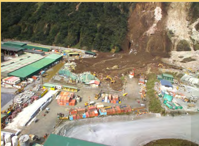
Longsor yang terjadi pada dinding timur Dispatch Ridge merupakan jenis longsor gabungan rock fall, landslide dan mud flow
