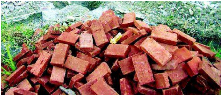
Bata-bata yang tidak disusun dengan rapi.
