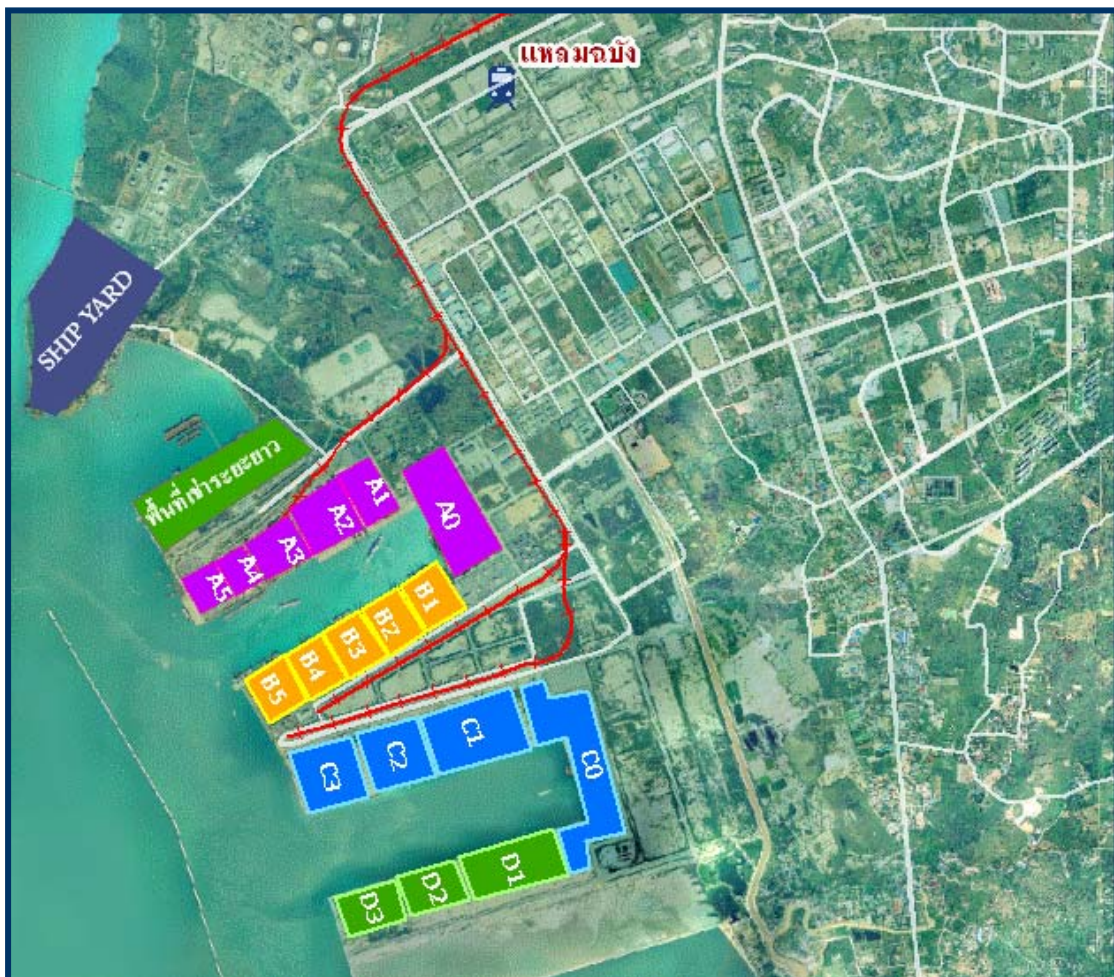
ภาพที่ 3-22 แสดงโครงข่ายรถไฟระหว่างสถานีแหลมฉบัง – ท่าเรือแหลมฉบัง
