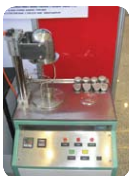
อุปกรณ์เตรียมชิ้นงานหล่อทดสอบ โดยระบบลดความดัน
