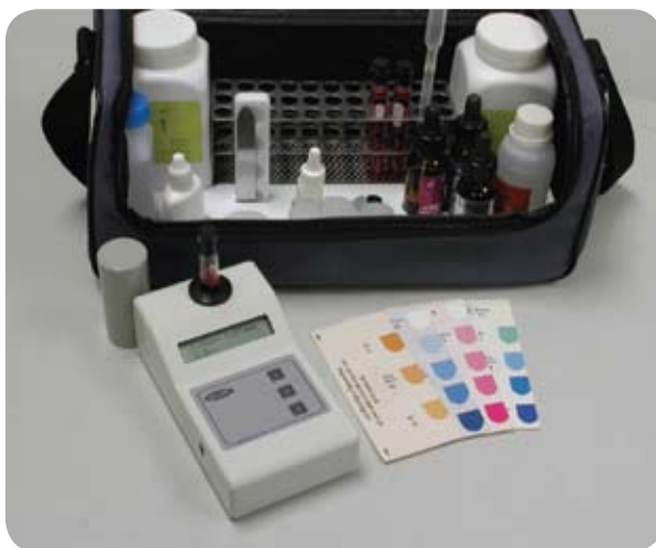
ต้นแบบเครื่องมือวัดราคาประหยัด สำหรับใช้กับชุดทดสอบที่มีตัวอย่าง เป็นสารละลายบรรจุในหลอดแก้ว
