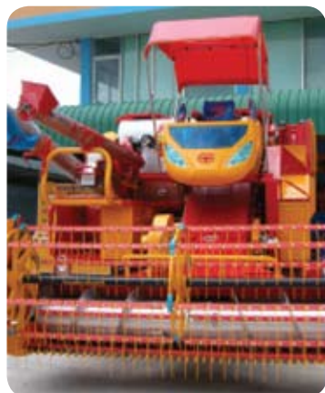
รูปแสดงไฟหน้ารถแบบใหม่ที่ ศว. ออกแบบ ติดตั้งบนรถเกี่ยวข้าวรุ่นใหม่ของบริษัท
