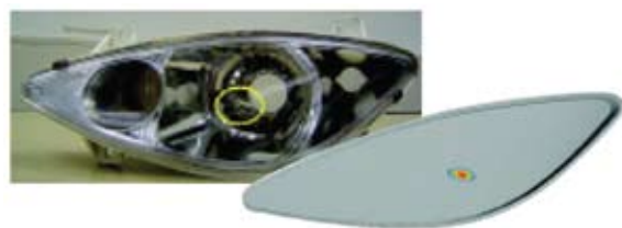
รูปแสดงจุดที่เกิดการละลายบนเลนส์พลาสติก ที่ได้จากการทดสอบจริงเทียบกับผลการวิเคราะห์
