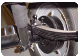
เพิ่มประสิทธิภาพการห้ามล้อ ด้วยระบบดรัมเบรกที่ติดตั้งกับสองล้อหลัง
