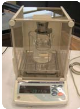
ชุดประเมินวัดความพรุนในชิ้นงานทดสอบ
