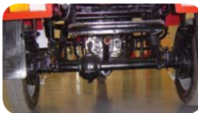
ชุดเพลามีการติดตั้งชุดเฟือง Differential เพื่อการถ่ายทอดกำลังแบบต่อเนื่อง
