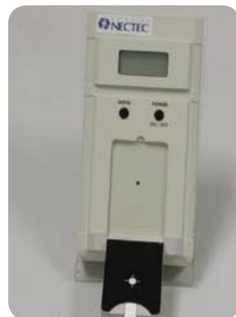
ต้นแบบเครื่องมือวัดราคาประหยัด สำหรับใช้กับชุดทดสอบ ที่มีตัวอย่างเป็นแถบทดสอบ
