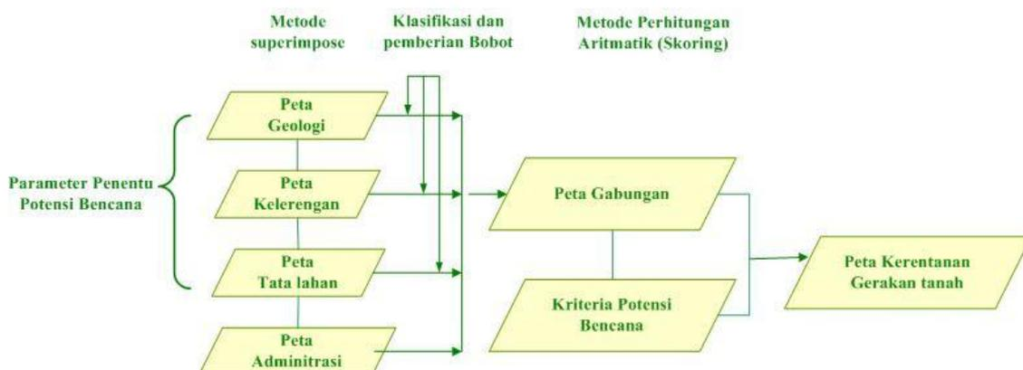
Gambar 3. Prosedur Analisis Tingkat Kerawanan Bencana Gerakan Tanah
