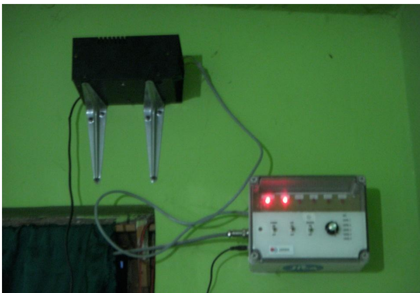
Gambar 4.8 Penguat sinyal dan monitor modifikasi desain Yani
