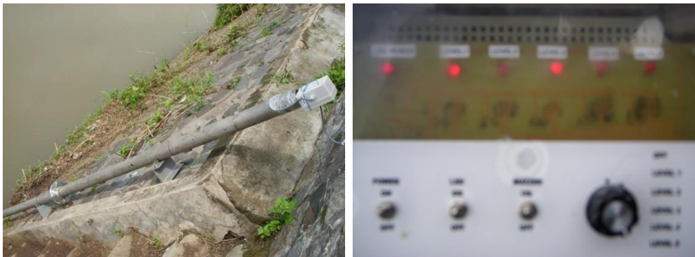
Gambar 4.7 Sensor muka air (kiri) dan monitor(kanan) rancangan Mr. Ueno bantuan JICA
