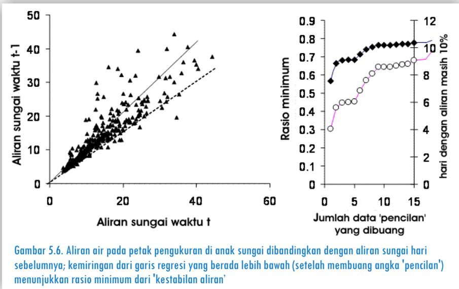
Gambar 5.6. Aliran air pada petak pengukuran di anak sungai dibandingkan dengan aliran sungai hari sebelumnya; kemiringan dari garis regresi yang berada lebih bawah (setelah membuang angka 'pencilan') menunjukkan rasio minimum dari 'kestabilan aliran'
