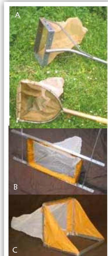
Gambar 4.2. Jaring untuk mengambil contoh makroinvertebrata; (A) Drift net sampler untuk melakukan 'kick sampling' dan (B) Drift net sampler untuk di pasang di dasar sungai; (C) Surber sampler net (Foto: Andy Dedecker dan Ans Mouton (gambar A); [www.pearce-environment.co.uk/acatalog/Pond\\_Eq...](http://www.pearce-environment.co.uk/acatalog/Pond_Eq...) (gambar B dan C))
