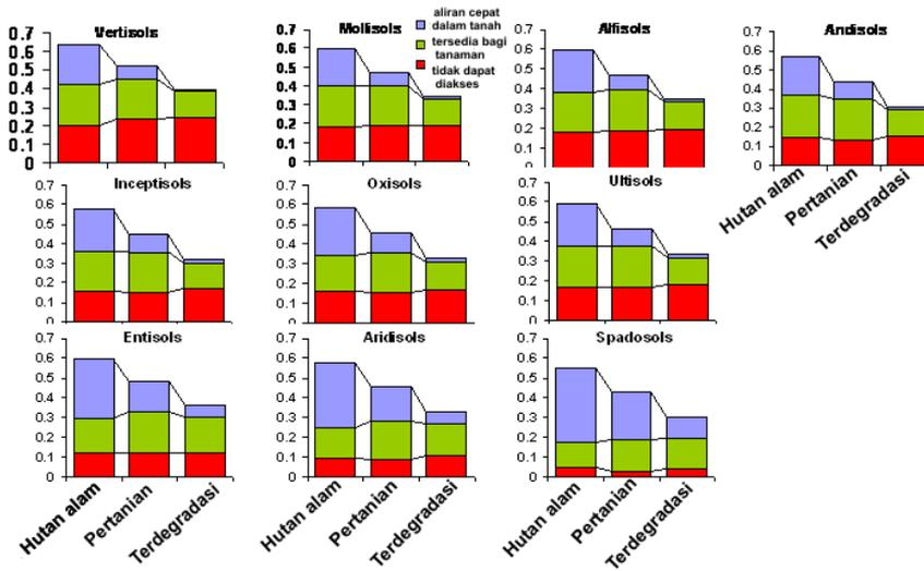
Gambar 5.8. Batas atas pengaruh pemadatan tanah terhadap kurva retensi air yang diduga menggunakan fungsi pedotransfer dari Wösten et al. (1998) berdasarkan data tanah di daerah tropik (Suprayogo et al., 2003), dengan mengasumsikan bahwa tanah hutan alam memiliki berat isi 0,7 kali tanah pertanian, sementara tanah yang terdegradasi meningkat kerapatannya hingga mencapai 1,3 kali.
