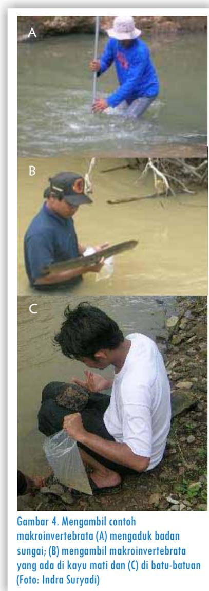
Gambar 4. Mengambil contoh makroinvertebrata (A) mengaduk badan sungai; (B) mengambil makroinvertebrata yang ada di kayu mati dan (C) di batu-batuan (Foto: Indra Suryadi)
