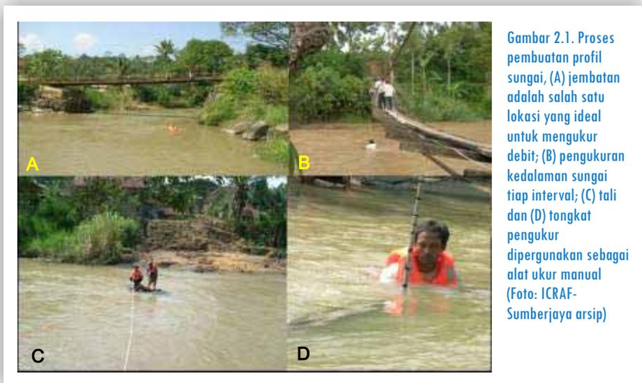
Gambar 2.1. Proses pembuatan profil sungai, (A) jembatan adalah salah satu lokasi yang ideal untuk mengukur debit; (B) pengukuran kedalaman sungai tiap interval; (C) tali dan (D) tongkat pengukur dipergunakan sebagai alat ukur manual (Foto: ICRAF-Sumberjaya arsip)
