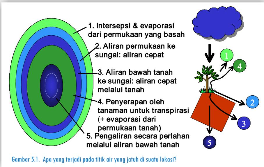
Lima jalur yang dapat dilalui titik hujan: dua jalur mengantarkan kembali ke atmosfer (evaporasi dari tajuk tanaman yang mengintersepsi curah hujan dan evapotranspirasi dari dalam tanah), dan tiga jalur akan mengantarkan ke jaringan sungai dalam waktu yang berbeda (aliran permukaan tanah- 'quick flow', aliran cepat di bawah permukaan tanah – 'sub surface flow' dan air tanah yang dialirkan secara perlahan-lahan – 'low flow')
