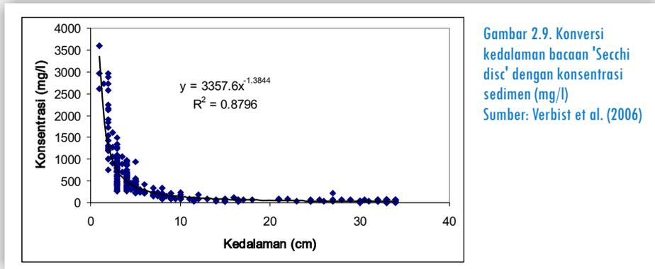
Tingkat ketelitian pengamat dalam membaca 'Secchi disc' dan ukuran partikel terlarut di sungai menentukan akurasi hasil penetapan sedimen. Akurasi bacaan 'Secchi disc' terbaik diperoleh pada kisaran kedalaman 10-30 cm. Pada kedalaman kurang dari 10 cm, hasil bacaan kurang akurat karena air terlalu keruh (Gambar 2.10).
