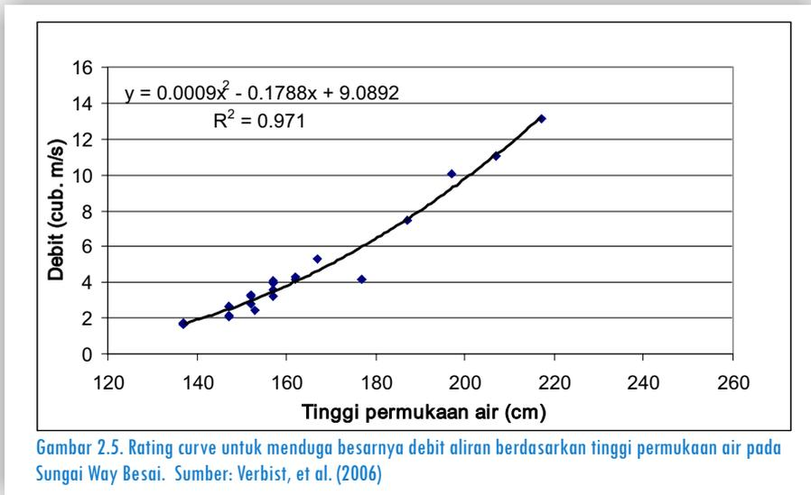
Gambar 2.5. Rating curve untuk menduga besarnya debit aliran berdasarkan tinggi permukaan air pada Sungai Way Besai. Sumber: Verbist, et al. (2006)
