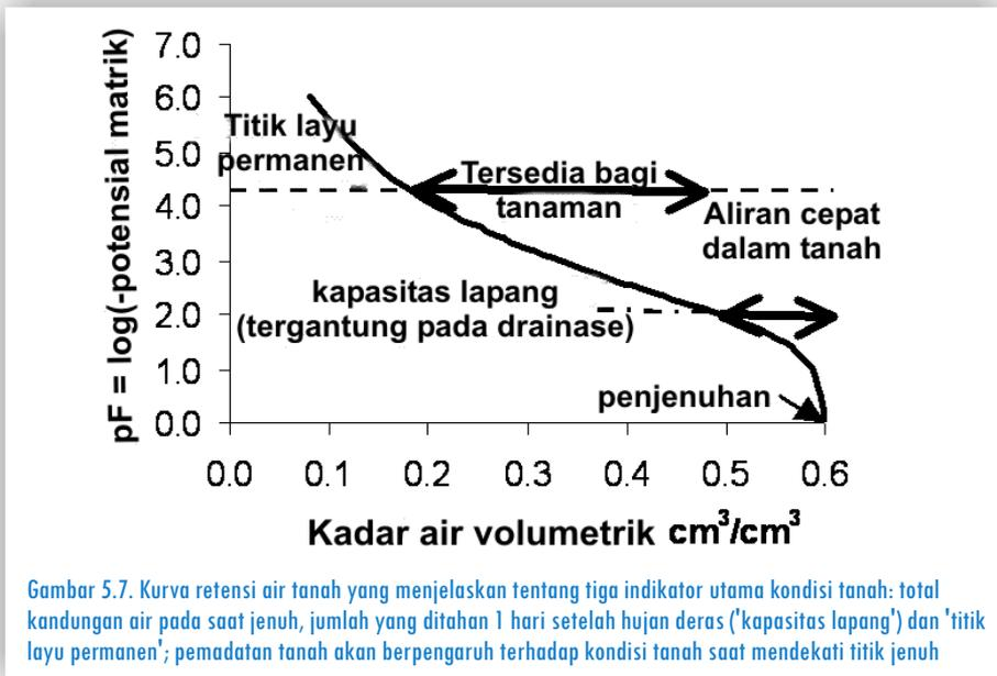
Gambar 5.7. Kurva retensi air tanah yang menjelaskan tentang tiga indikator utama kondisi tanah: total kandungan air pada saat jenuh, jumlah yang ditahan 1 hari setelah hujan deras ('kapasitas lapang') dan 'titik layu permanen'; pemadatan tanah akan berpengaruh terhadap kondisi tanah saat mendekati titik jenuh
