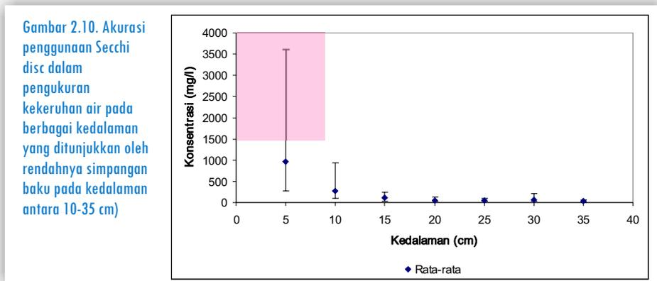
Selain pada kedalaman di bawah 10 cm, 'Secchi disc' juga menunjukkan pengukuran yang kurang akurat apabila konsentrasi sedimen lebih dari 500 mg/l (Gambar 2.11).
