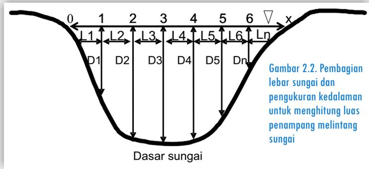
Gambar 2.2. Pembagian lebar sungai dan pengukuran kedalaman untuk menghitung luas penampang melintang sungai
