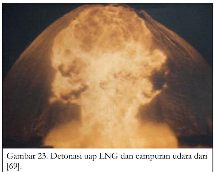
Gambar 23. Detonasi uap LNG dan campuran udara dari [69].
