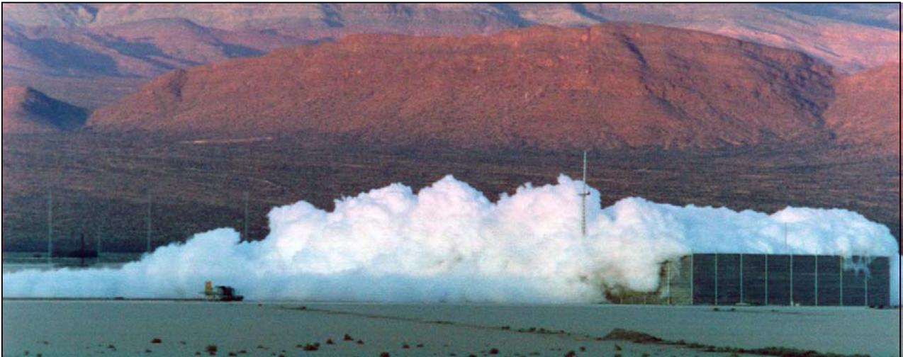
Gambar 19. Percobaan mengisikan awan gas alam yang menyebar-luas dengan penghalang fisik (Percobaan penghalang uap Falcon LNG, Nevada Test Site 1987, dari [41]).
