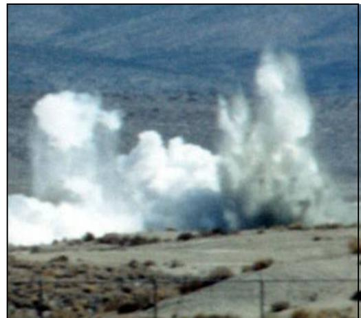
Gambar 21. Percobaan Burro DOE dengan penyebaran uap LNG, dimana Transisis Fase Cepat menunjukkan perilaku ledakan [41]
