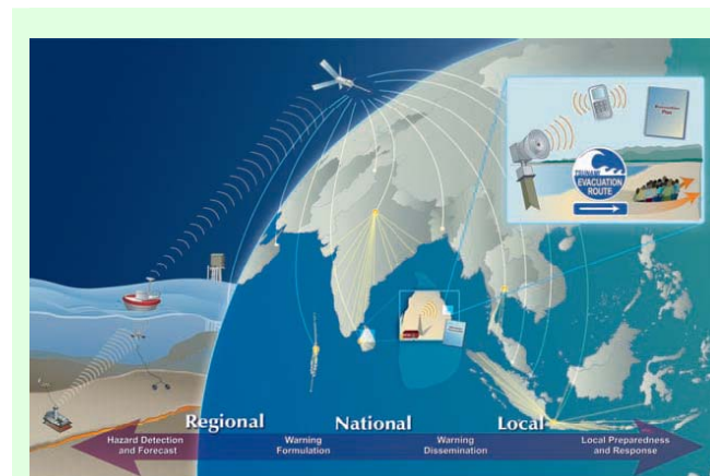
Gambar 3.1: Sistem Peringatan Dini Tsunami Indonesia (InaTEWS) menerapkan pendekatan 'End-to-End'.
