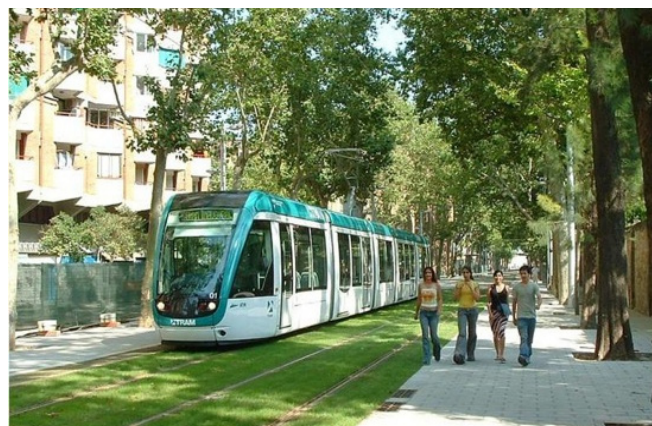
Foto 1: Lawn tram di Barcelona, Spain.
