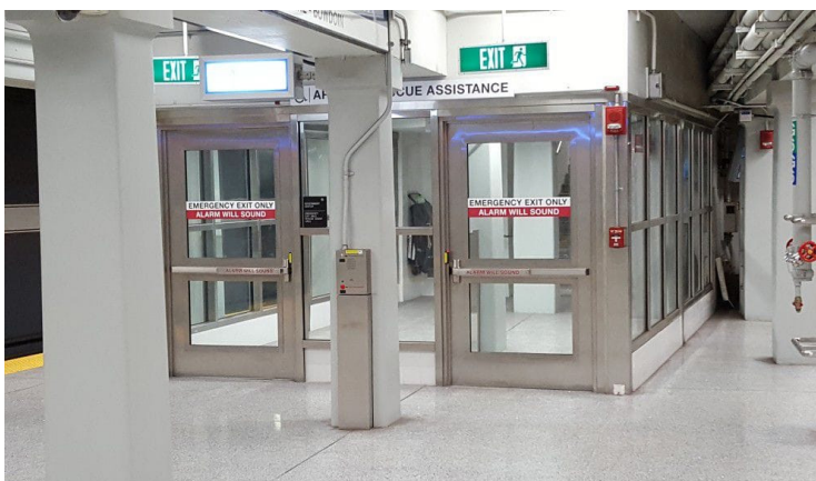
Foto 38: (Kiri) Government Centre Station, Boston, USA telah menyediakan satu ruang tertutup yang dikenali sebagai 'area of rescue assistance', untuk membolehkan penumpang termasuk golongan OKU berkumpul sementara menunggu bantuan kecemasan tiba. Ruang ini dilengkapi bekalan gas oksigen dan sistem intercom yang berhubung terus ke Pusat Kawalan Operasi Massachusetts Bay Transportation Authority . (Kanan) Struktur laluan keluar kecemasan ( emergency egress ) yang membolehkan penumpang keluar ke permukaan tanah di Government Centre Station.
