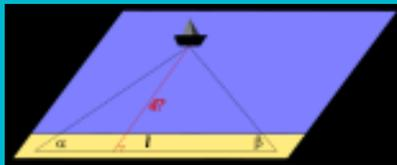
Triangulasi antara lain digunakan untuk menentukan *koordinat* dan *jarak* dari pantai ke kapal. Pengamat di A mengukur sudut  $\alpha$  antara pantai dan kapal, dan pengamat di B melakukan hal yang sama untuk  $\beta$ . Jika panjang  $l$  atau koordinat A dan B diketahui, maka hukum sinus dapat diterapkan dalam menentukan koordinat kapal di C dan jarak  $d$ .
