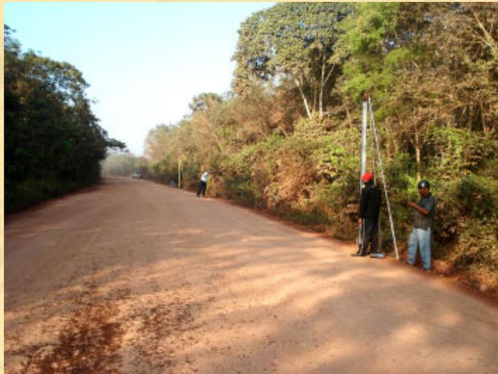
**Waterpasing pengukuran beda tinggi**
