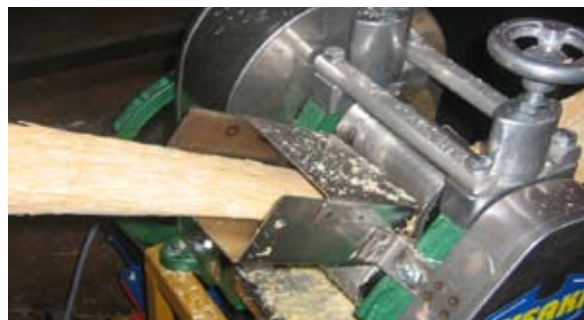
Pemerahan sap menggunakan teknik tekanan torak Sap squeezing technique via roller pressing
