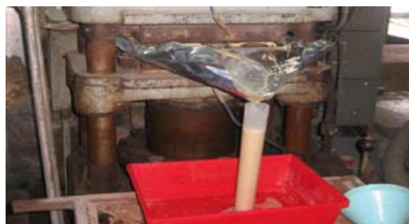
Pemerahan sap menggunakan teknik tekanan sejuk Sap squeezing technique via cold pressing
