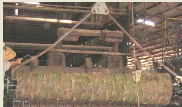
Proses membulat menggunakan pelarik kitaran Round-up process using rotary lathe
